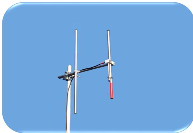
■ VHF NARROW BAND YAGI ANTENNA
